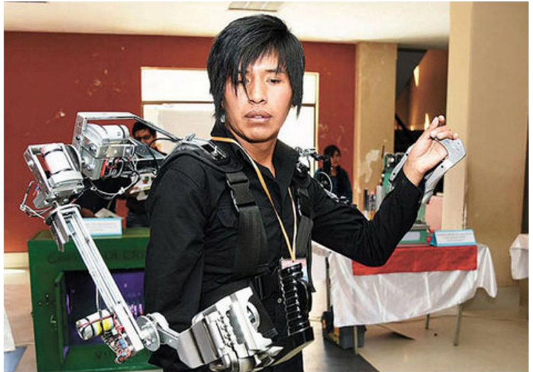
Ronald Mamani, estudiante de la carrera de Ingeniería Electrónica de la Universidad Pública de El Alto (UPEA), realiza en enero de 2017 la demostración de su prototipo de exoesqueleto, el primero diseñado en Bolivia, con capacidad para devolver la movilidad a personas con discapacidad motriz en las piernas. Fuente ilustración: bolivia.blogspot.com
